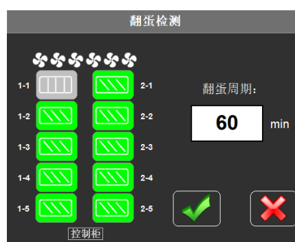
图 3-36 孵化车检测设置（1-1 不检测）
